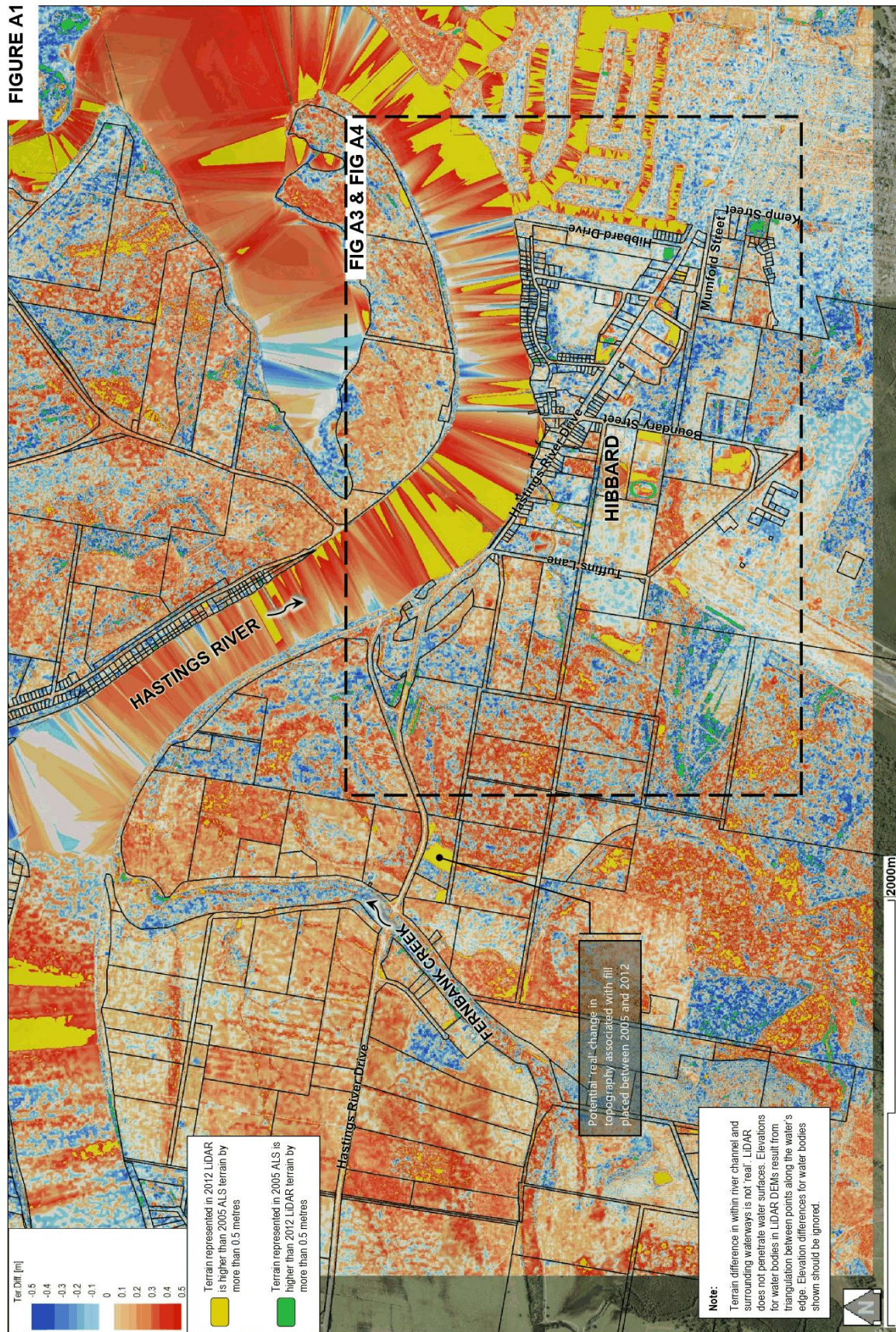
COMPARISON OF 2012 LIDAR to 2005 ALS (2012 LIDAR minus 2005 ALS) [Low Range of Changes – Extent 1]
